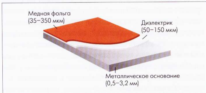
Рис.1. Конструкция односторонней печатной платы с металлическим основанием
