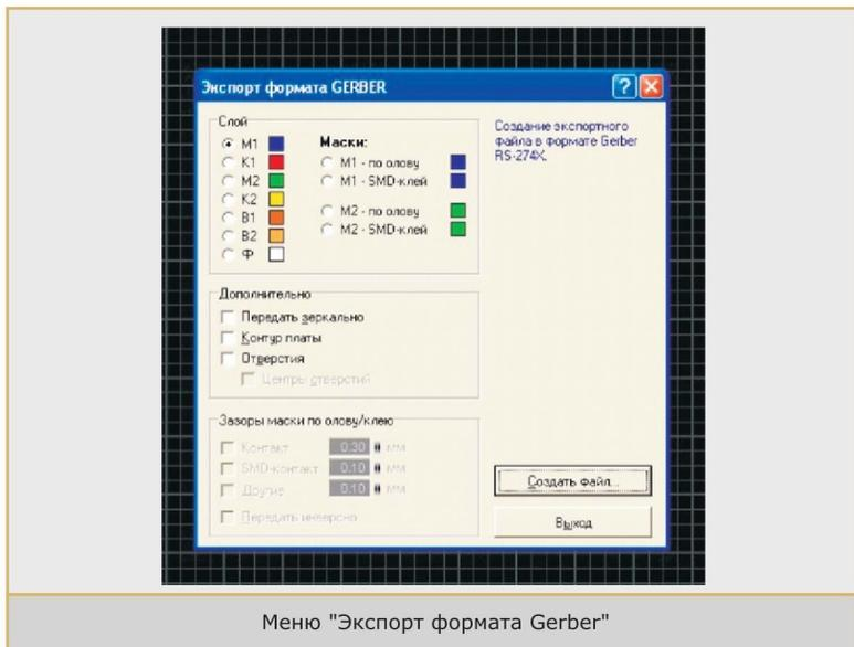
При экспорте нижних слоев 0.10 (M2, K2 и B2) необходимо снять галочку в поле «Дополнительно»- «Передавать зеркально».
